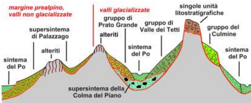
Fig. 1 - Unità non distinte in base al bacino di appartenenza: schema dei rapporti stratigrafici dei depositi di versante al raccordo versanti-pianura e in media valle.
