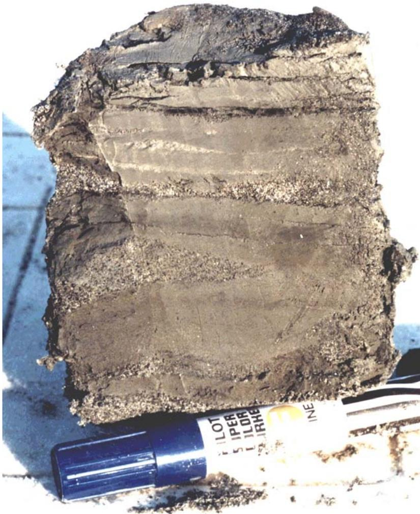
Fotografia 6.3 Gruppo Acquifero C, sondaggio *Pianengo RL 2*, profondità 128.0-128.1 m. Stratificazione da alternante a lenticolare, interpretabile come flaser o lenticular bedding.
