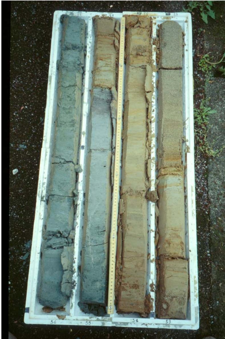
Fotografia 6.5 Gruppo Acquifero B, sondaggio *Agrate RL 4*, profondità 52-56 m. Si noti il passaggio da prevalenti sabbie ossidate (giallo ocra) a limi torbosi (grigio) depositi invece in ambiente riducente.
