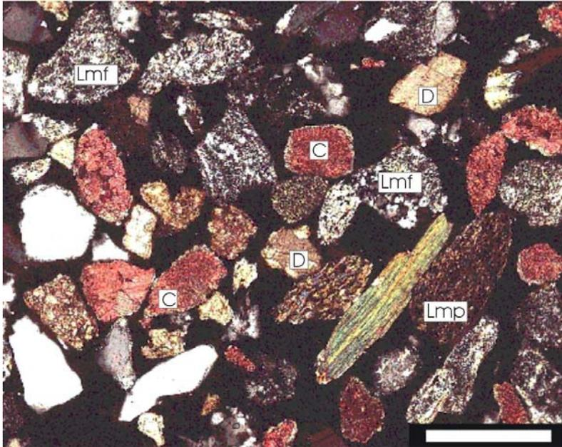
Fotografia 6.10 *Agrate RL 4* 175 m Petrofacies sudalpina mista con abbondanti litici sia carbonatici (C= calcarei; D= dolomitici) che metamorfici (Lmp= metapeliti; Lmf= metafelsiti), progressiva -175.4 m; 43 m al di sotto della superficie stratigrafica di 0.8 Ma, tetto del Gruppo Acquifero D. La composizione non è perfettamente confrontabile con nessuno dei sedimenti attuali dei fiumi lombardi. Nicol incrociati. Scala = 250 micron.
