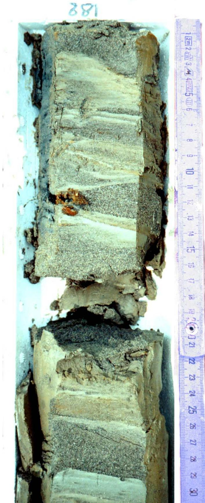
Fotografia 6.4 Gruppo Acquifero D, sondaggio *Agrate RL 4*, profondità 182.0-182.3 m. Laminazioni oblique ad alto angolo in alternanze sabbia-limo. Si notino i frammenti vegetali ossidati a 182.1 m.
