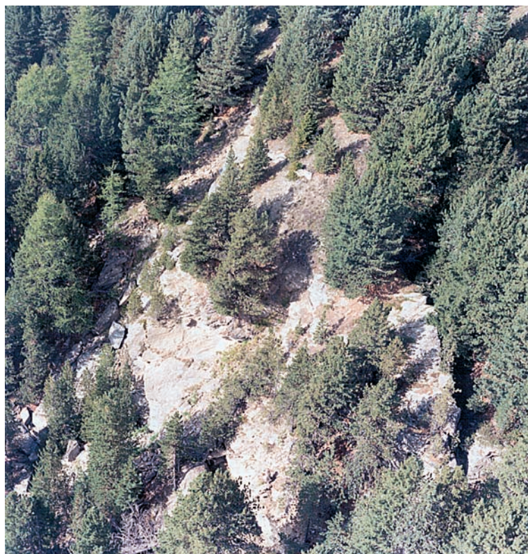
Fig. 89: Alta Valfurva (SO), sackung del Ruinon. La porzione attiva nella parte medio-bassa del versante mostra evidenti segni di movimento. In basso nella foto si può osservare una trincea aperta.
