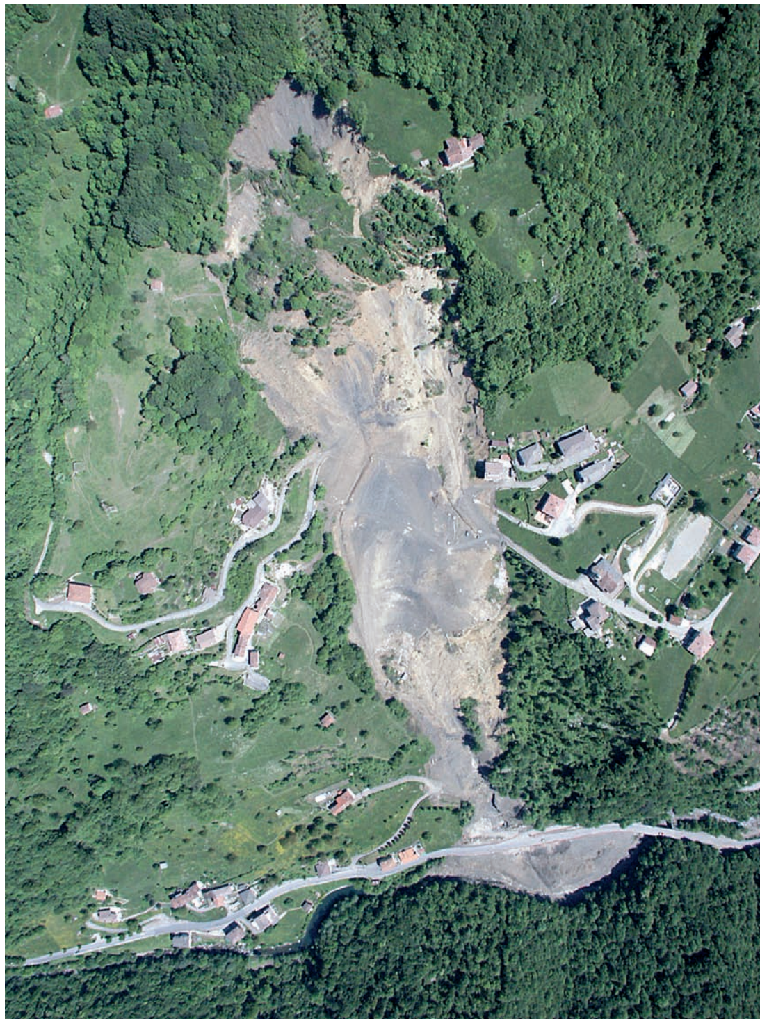
Fig. 29: Brembilla (BG), scivolamento rotazionale, novembre 2002. L'evento ha causato la distruzione dell'abitato della località Camorone.
