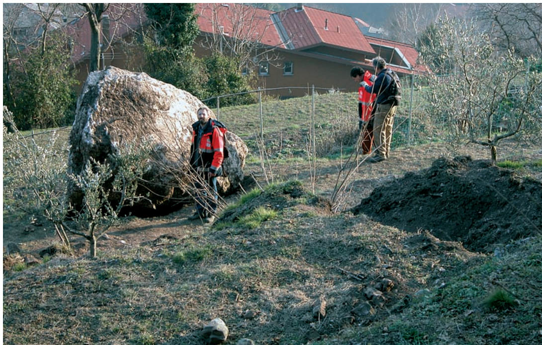
Fig. 16: Caslino d'Erba (CO), traccia di impatto lasciata da un grosso masso di circa 50-60 m 3 staccatosi dalla parete rocciosa soprastante. Il masso si è poi fermato a distanza di pochi metri. Il dislivello percorso è stato di circa 100 m.
