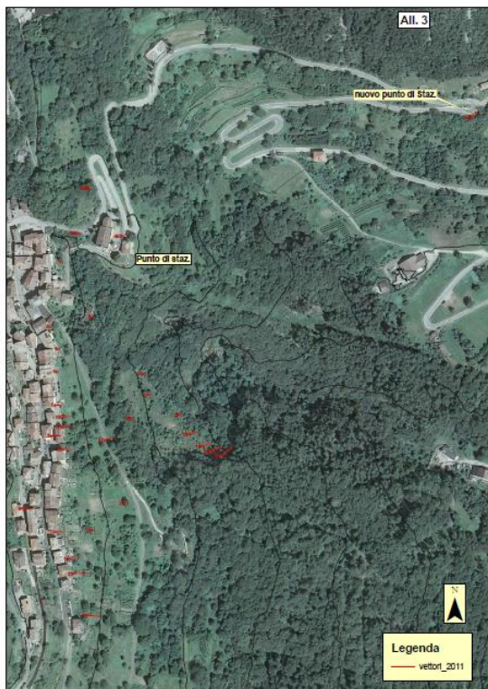
Fig. B101 – Estratto dell’ortofoto con il monitoraggio del movimento deformativo di Castel Condino, con le ubicazioni dei capisaldi e le direzioni dei vettori attendibili (DEGASPERI, 2012a).
