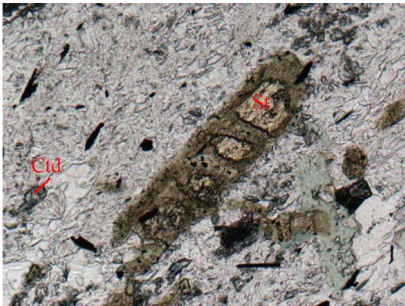
Fig. A27 – Staurolite (St) microboudinata con crescita di mica bianca e clorite, al centro dei colli. Probabile boudinage in due fasi in cui prima cresce mica e poi clorite. Nella matrice di mica bianca fine sono anche dispersi piccoli granuli di cloritoide (Ctd) con bordi irregolari. Foto con solo polarizzatore; lato lungo 0,86 mm (foto D. Zanoni).
