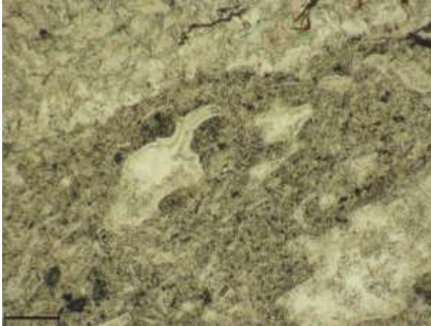
Fig. A32 - Shard vetrosi incurvati nella pasta di fondo di una fiamma. Microfoto a polarizzatori paralleli (scala di riferimento 125 \mu m).
