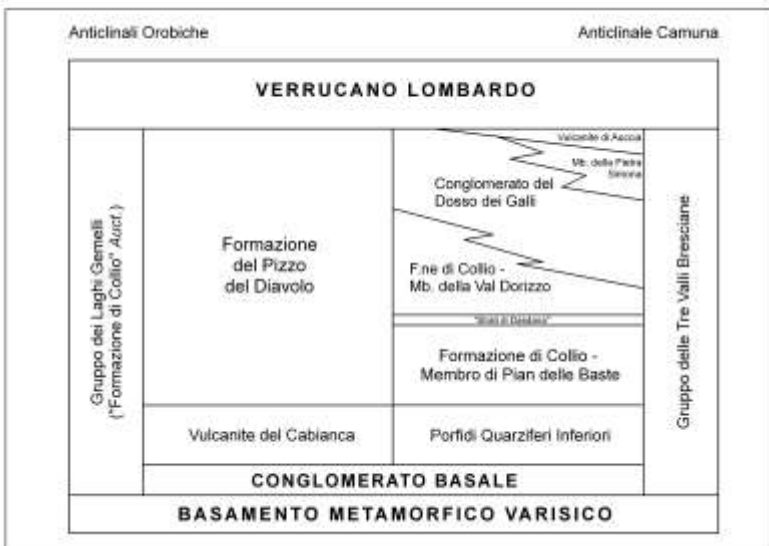
Fig. A29 – Schema della successione vulcano-sedimentaria affiorante nel settore delle anticlinali orobiche e camuna (Comitato d'area per le Alpi centrali, orientali ed occidentali, 2005).
