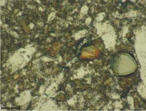
Fig. A57 - Conglomerato del Verrucano Lombardo (VER) a tetto della litozona superiore della vulcanite di Auccia a Punta dell'Auccia. Ciottoli di colore verde scuro, nerastro costituiti da quarzo e tormalina. Ciottoli analoghi si riscontrano anche nel Conglomerato della Val Daone (VER 1 ). Microfoto a polarizzatori paralleli (scala di riferimento 125 µm).
