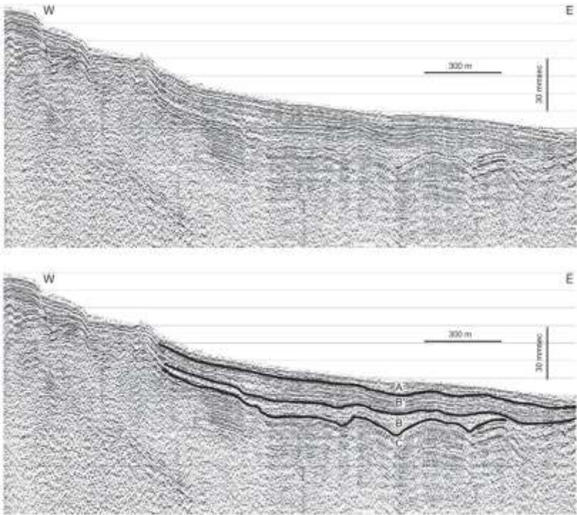
*Fig. 26 - Profilo sismico monocanale attraverso il Bacino di Sarnico: le Sequenze A e B ammantano una preesistente topografia; la Sequenza B' è coperta in discordanza dai depositi della sequenza A (da BINI et alii, 2007).*
