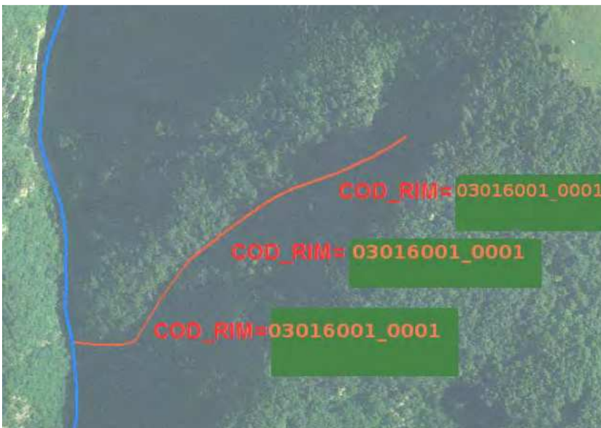
Foto 3 Corso d'acqua minore caratterizzato da 3 archi, tutti avente stesso valore di COD_RIM
